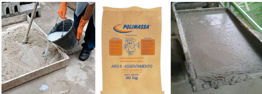
Figura 8: Tipos de argamassa, da direita para a esquerda: i- argamassa com dosagem em obra; ii- argamassa industrializada; iii- argamassa usinada.
