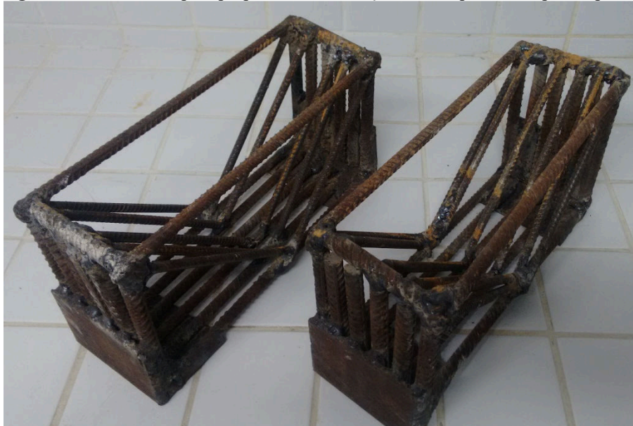
Figura 18: Mecanismo para proporcionar inclinação de 45°, para os corpos de prova.
