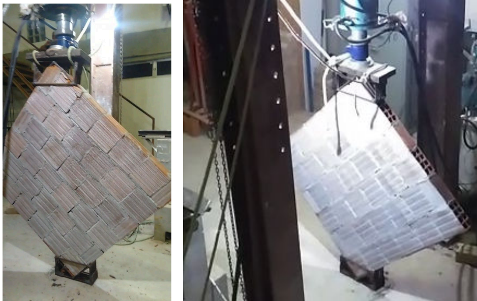
Figura 32: Posicionamento do corpo de prova para ensaio de cisalhamento.
