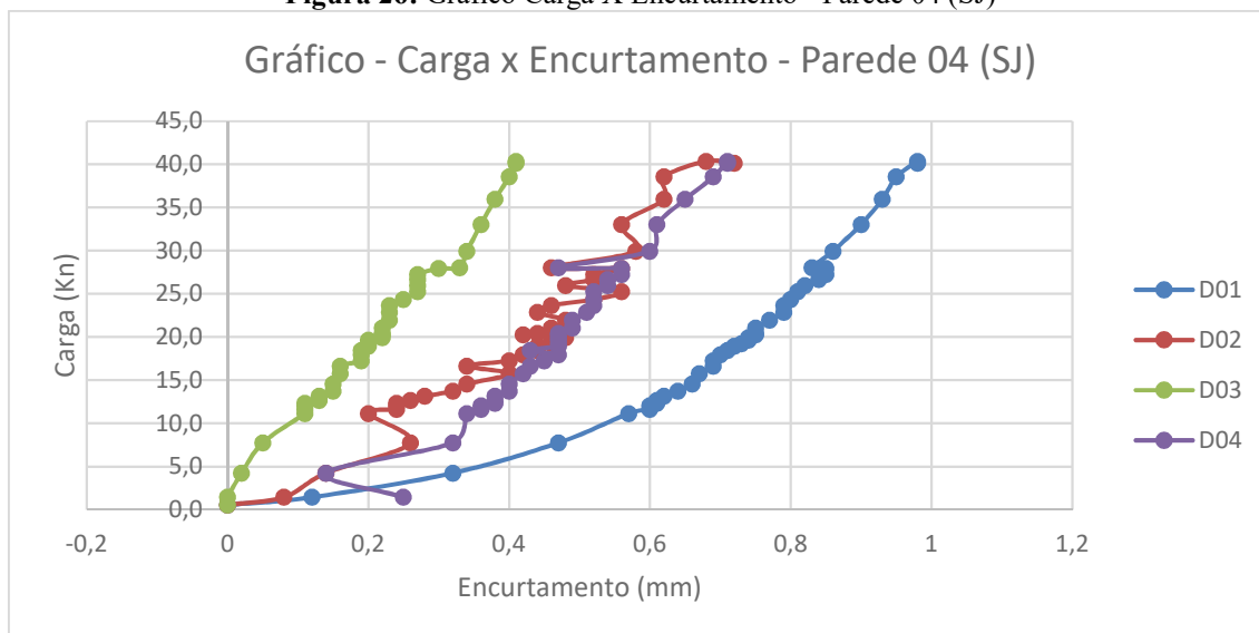
Figura 26: Gráfico Carga X Encurtamento - Parede 04 (SJ)
