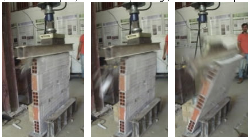
Figura 21: i-Momento da ruptura; ii- Descentralização da carga; iii- Tombamento da parede 01 (CJ).
