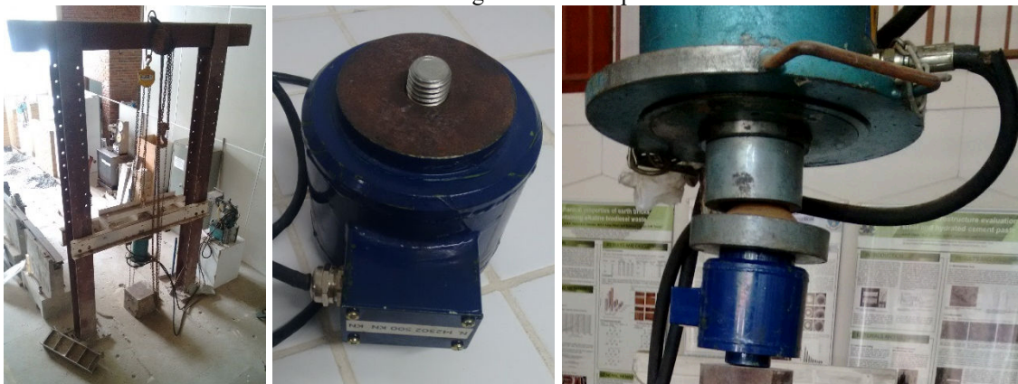
Figura 16: i- Pórtico com prensa hidráulica; ii- Célula de carga de 500Kn; iii- Prensa hidráulica com célula de carga instalada na ponta.
