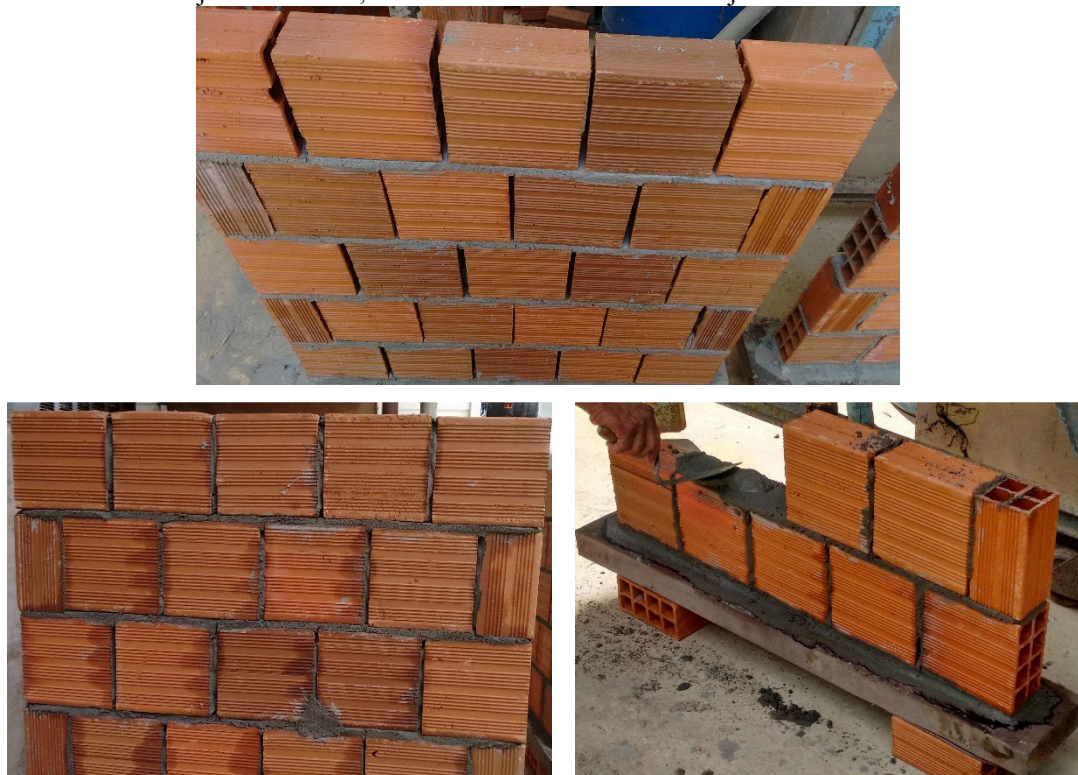
Figura 17: Corpos de prova utilizados para os ensaios: i- Parede sem juntas verticais; ii- Parede com juntas verticais; iii- Parede sendo construída com juntas verticais.
