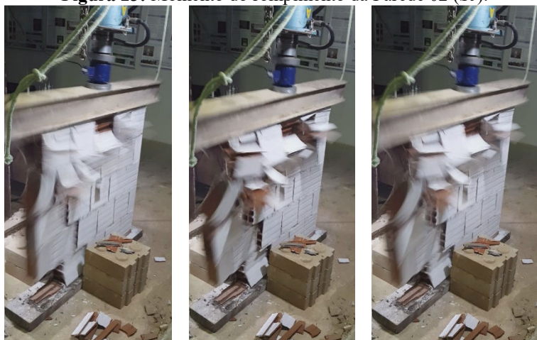
Figura 23: Momento do rompimento da Parede 02 (SJ).
