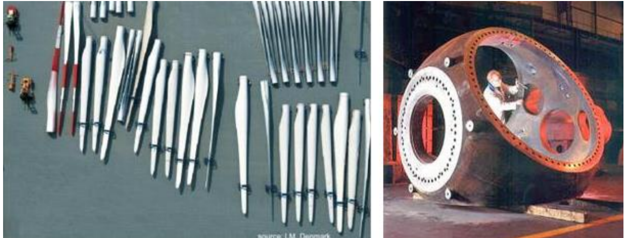
Figura 14 – Detalhe de um páteo com pás (esq.) e de um cubo (dir.)
