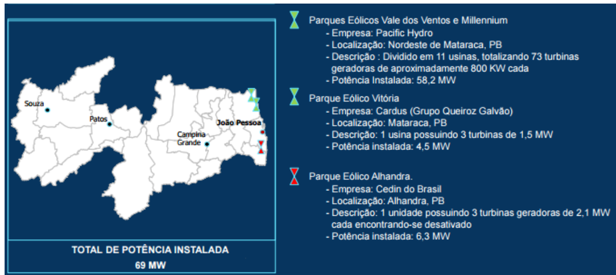
Figura 22 – Posicionamento das Geradoras de Energia Eólica
