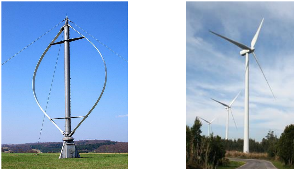
Figura 12 – Turbina eólica de eixo vertical (esq.) e de eixo horizontal (dir.)
