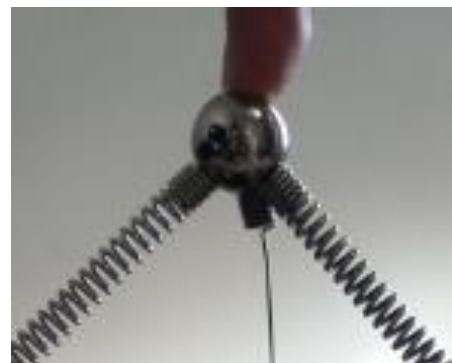
Figura 11 - Esfera Metálica em ligação articulada
