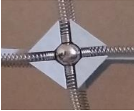
Figura 12 - Ligação enrijecida por quatro peças RC90.
