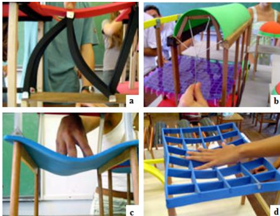
Figura 5 - a) Compressão nas barras de uma treliça; b) Treliça com barras tracionadas; c) Laje maciça com flexão em uma direção; d) Laje nervurada.
