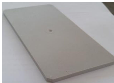
Figura 17 - Elemento rígido para lajes ou paredes estruturais.
