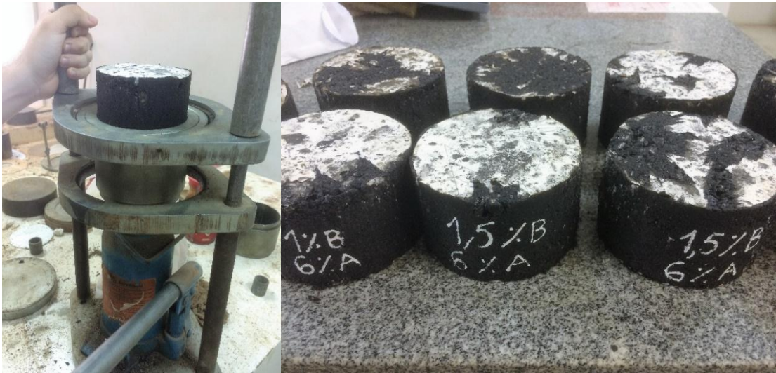
Figura 18 – Desmolde do corpo de prova (a); Corpos de prova desmoldados (b)
