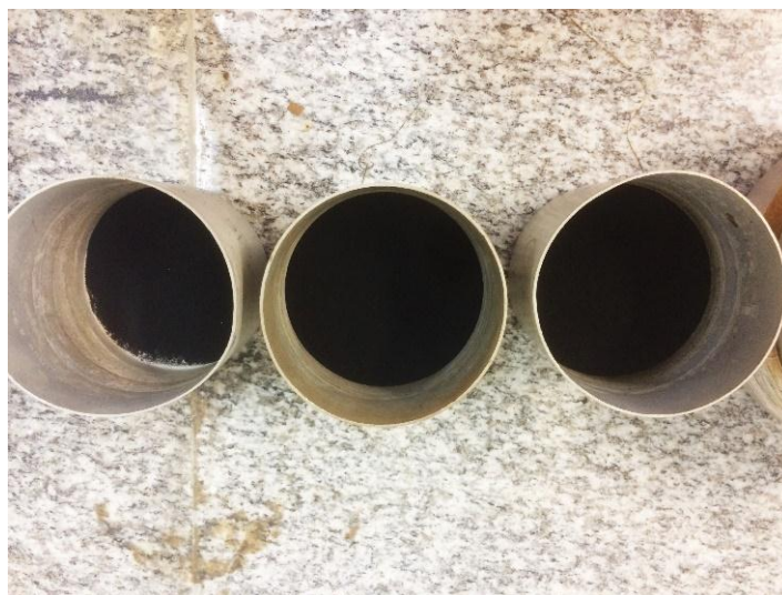
Figura 10 – Borrachas peneiradas nas frações (a) 2 mm – 0,42 mm; (b) 0,42 mm – 0,3 mm; e (3) passantes na 0,3 mm
