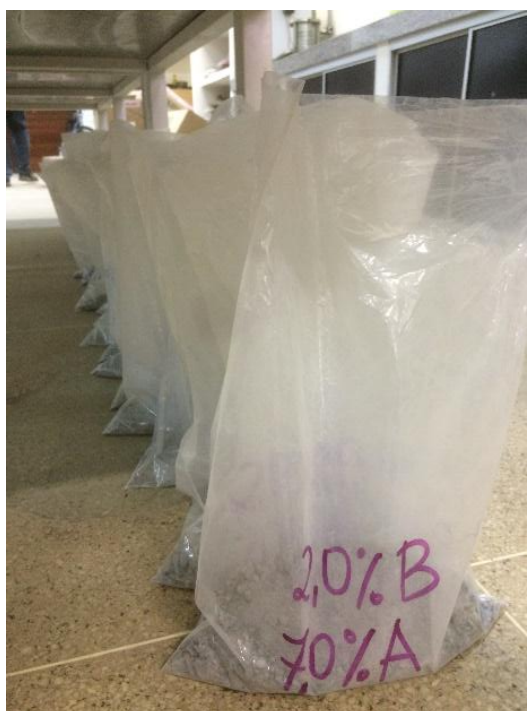
Figura 12 – Preparação dos agregados para a moldagem dos corpos de prova
