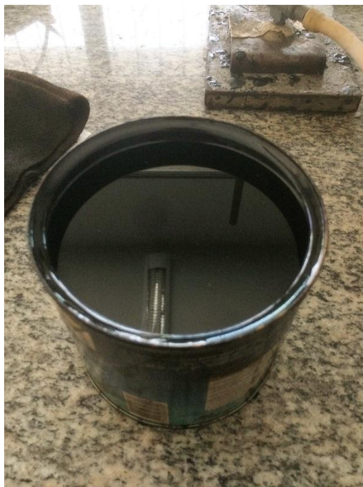
Figura 6 – Ligante asfáltico utilizado na mistura
