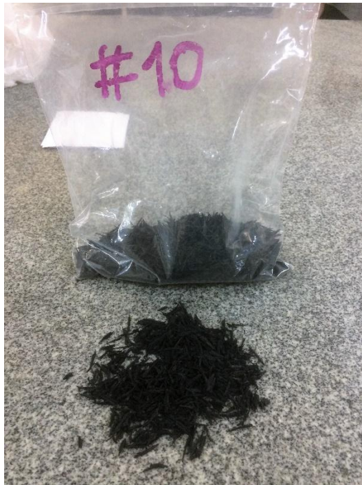
Figura 9 – Borrachas peneiradas na fração 4,8 mm – 2 mm
