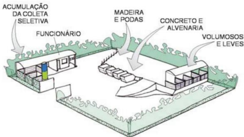
Figura 3 – Desenho Esquemático de um Eco Ponto – Ministério do Meio Ambiente.
