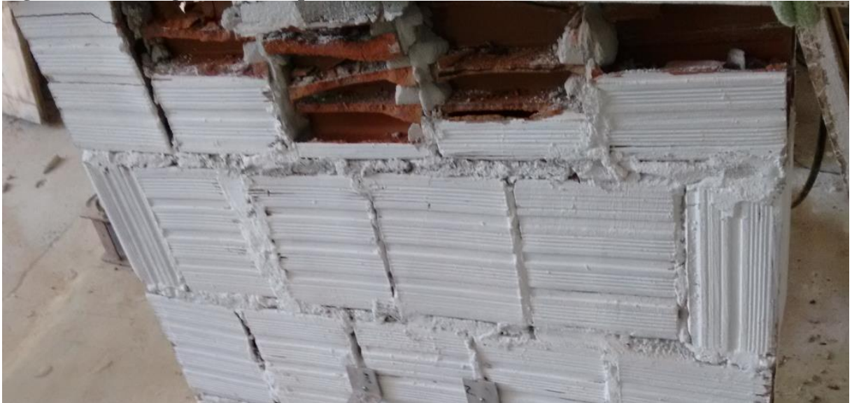
Figura 25 – Esmagamento completo da última fiada
