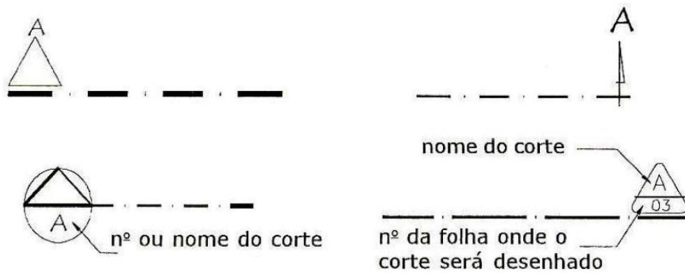
Figura 69 - Representações alternativas de marcação de cortes
