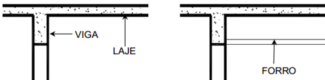
Figura 39 - Representação de laje e forro
