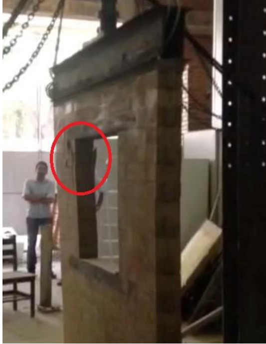
Figura 33. Ruptura da Parede 1. Fonte: Acervo próprio.
