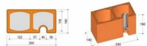
Bloco Hidráulico com passagem de duto externo
