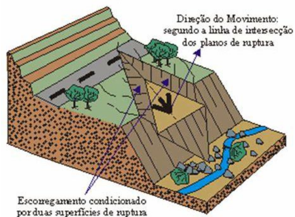
Figura 4 - Esquemática de deslizamentos em cunha
