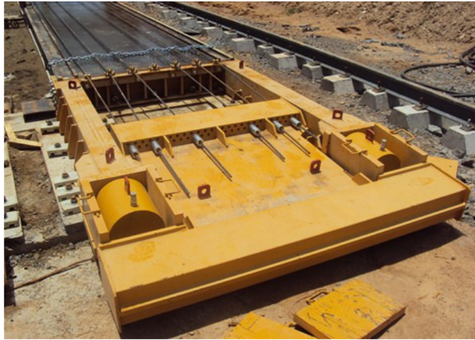
Figura 1 – Pista de protensão
