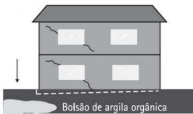
Figura 8 - Problema com a adoção de projeto com perfil de solo inadequado.
