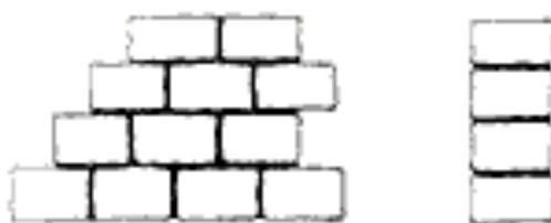
Figura 4 – Alvenaria de pano único com pedras regulares
