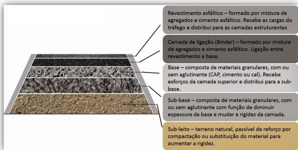
Figura 50. Estruturas do pavimento. Fonte: http://asfaltodequalidade.blogspot.com .
