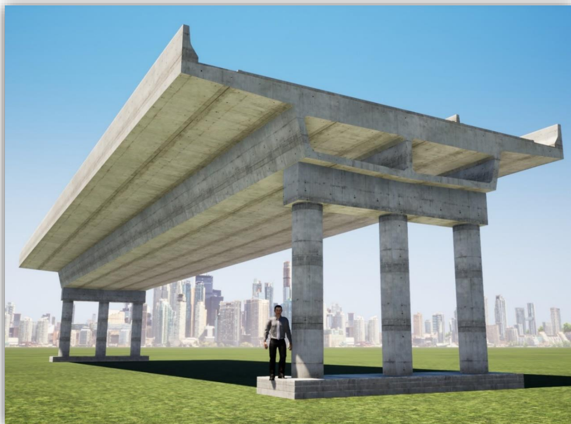
Figura 99. Superestrutura com seção multicelular.
