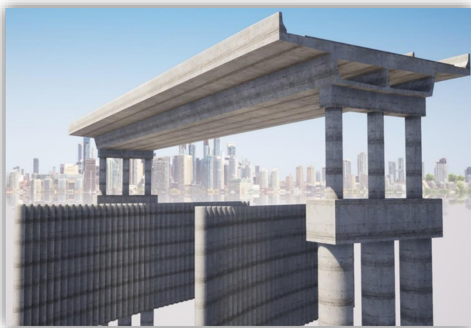
Figura 96. Croqui para visualização da fundação do viaduto e da contenção da passagem de nível inferior.
