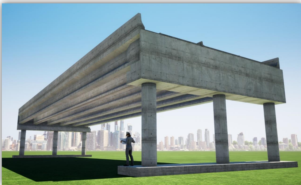
Figura 100. Superestrutura com seção de vigas múltiplas.
