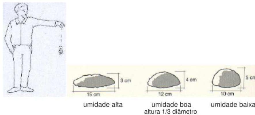
Figura 4 - Maneira prática de se determinar a consistência do material em adobes.
