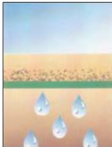
Figura 16 - Geossintético exercendo a função de filtro
