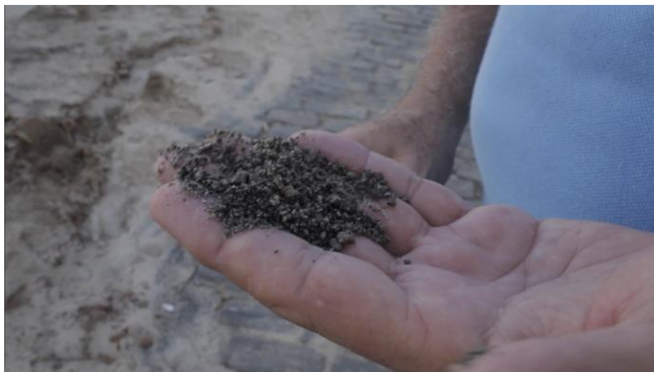
Figura 23 - Escória de chumbo desencavado em obra no Centro de Santo Amaro
