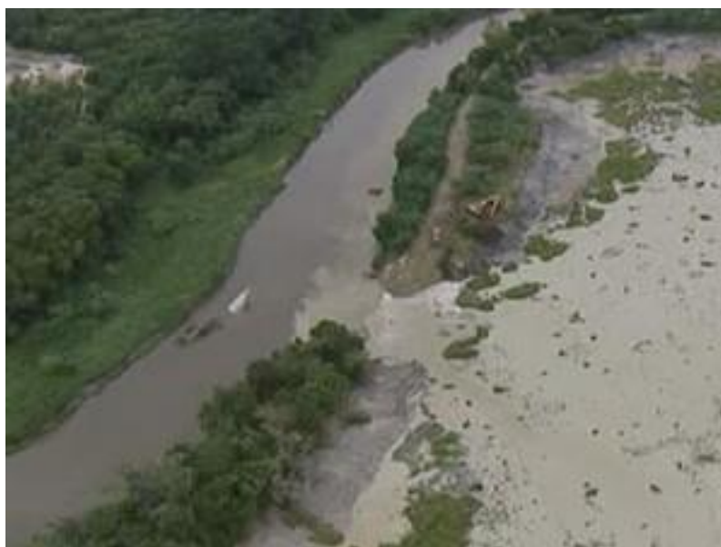
Figura 24 - Rompimento de barragem de areia em Jacareí
