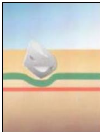
Figura 20 - Geossintético exercendo a função de proteção
