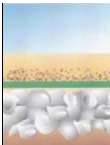
Figura 13 - Geossintético exercendo a função de separação
