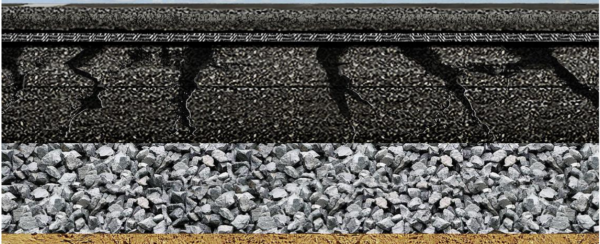
Figura 15 - Geossintético separando pavimento fissurado e revestimento novo
