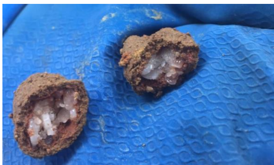
Figura 5: Hidróxido de Sódio não reagido envolvido pela terra
