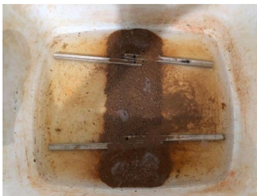
Figura 12: exemplo de perda de massa dos blocos
