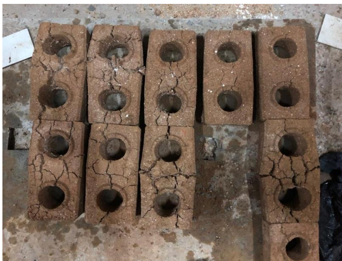
Figura 1: Fissuras nos blocos confeccionados com Cal Virgem Frente C
