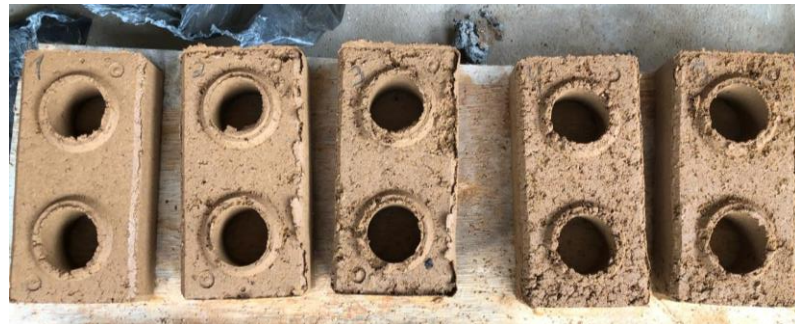
Figura 8: Visualização da interferência do tempo de pega
