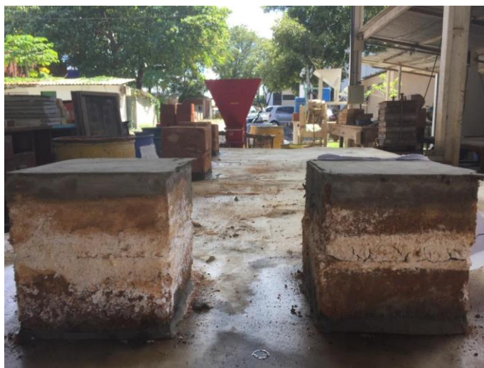
Figura 3: BTC cortados e capeados
