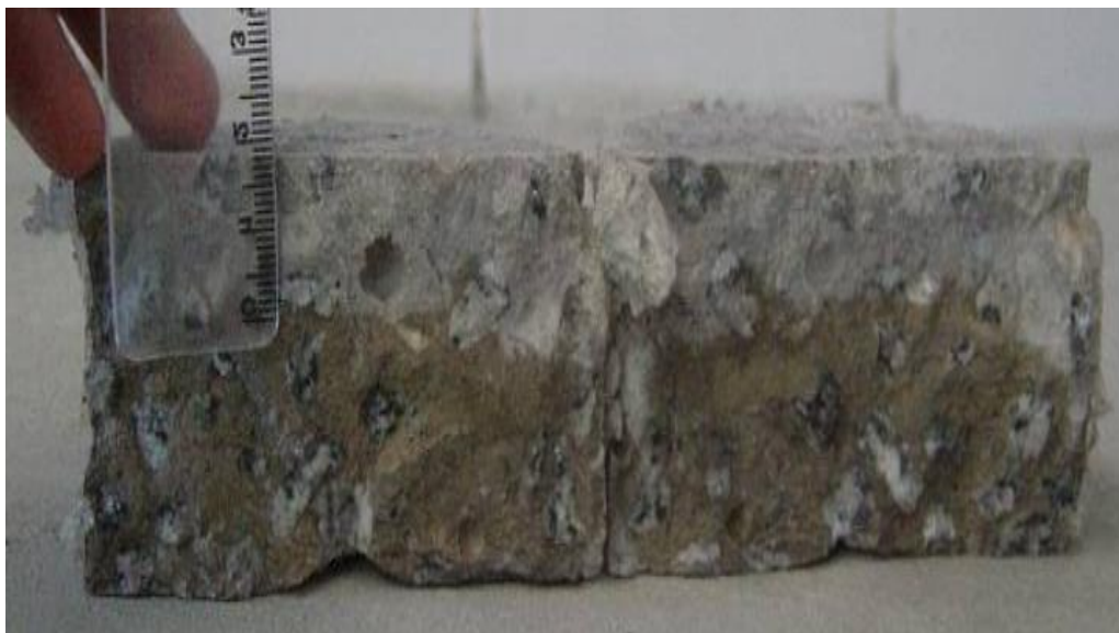
Figura 25 - Possível precipitação de cloretos livres (branco) e cloretos combinados (marrom).
