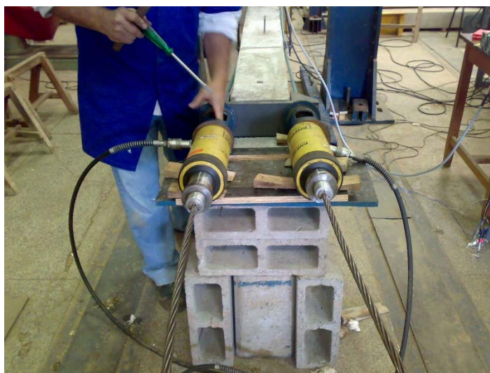
Figura 17 – Macaco de protensão.
