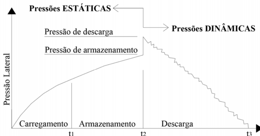
Figura 4 – Pressões nas paredes de um silo para os três estágios de operação: carregamento, armazenamento e descarga.
