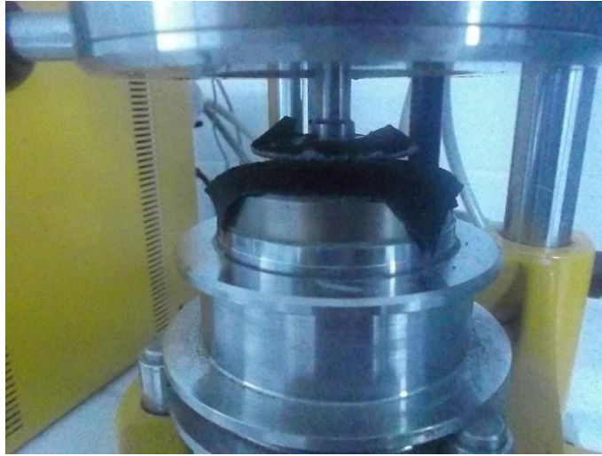
Figura 07 – Detalhe da utilização das fitas anti derrapantes
