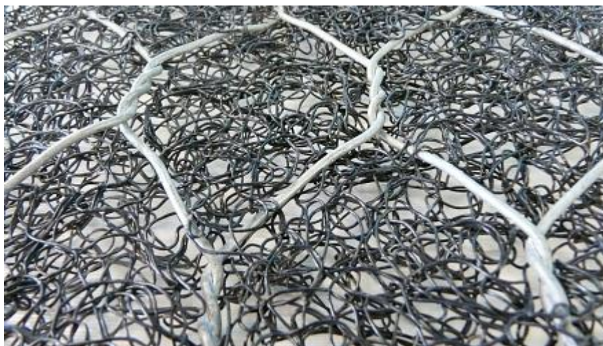
Figura 46 – Geomanta reforçada MacMat® (Maccaferri)
