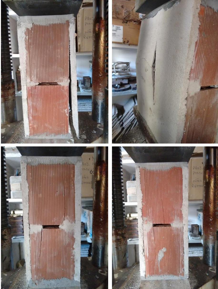
Figura 27 – Fissuras no rompimento dos prismas tipo 3
