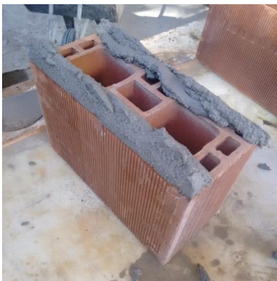
Figura 11- Configurações reais dos prismas que foram estudados (a) Tipo 1 (b) Tipo 2 (c) Tipo 3
