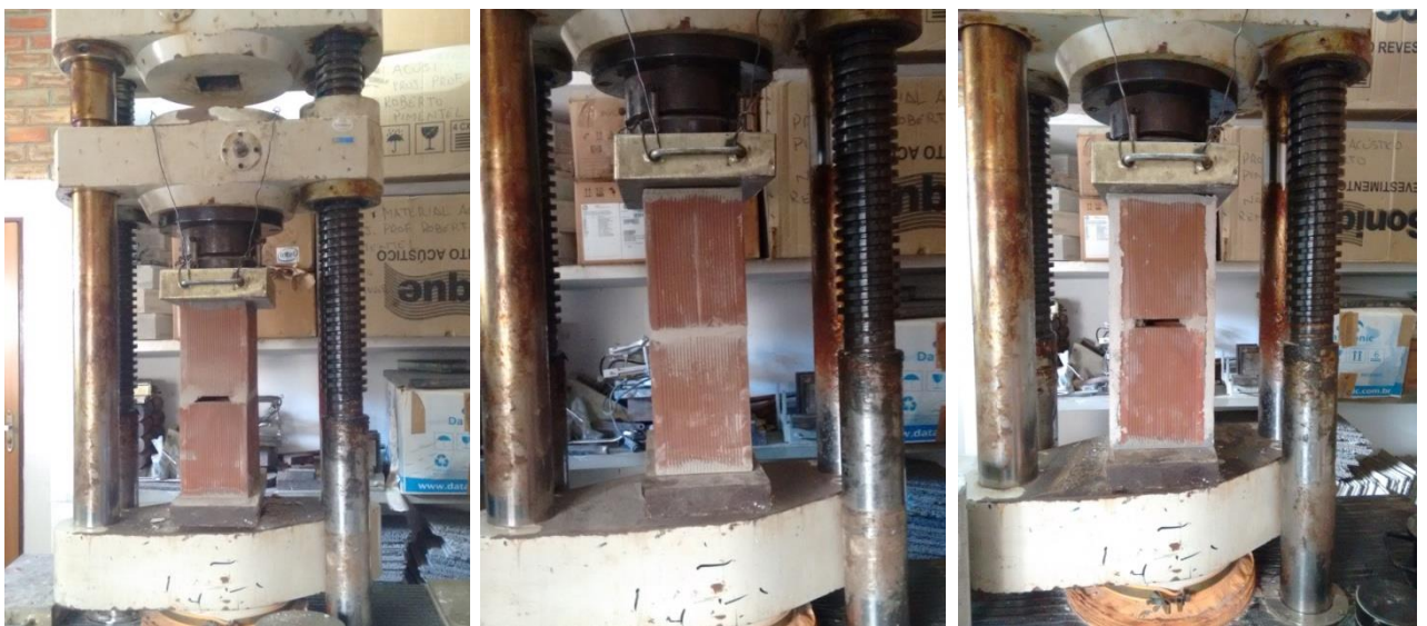
Figura 22 - Ensaio de compressão (a) Prismas tipo 1 (b) Prismas tipo 2 (c) Prismas tipo 3
