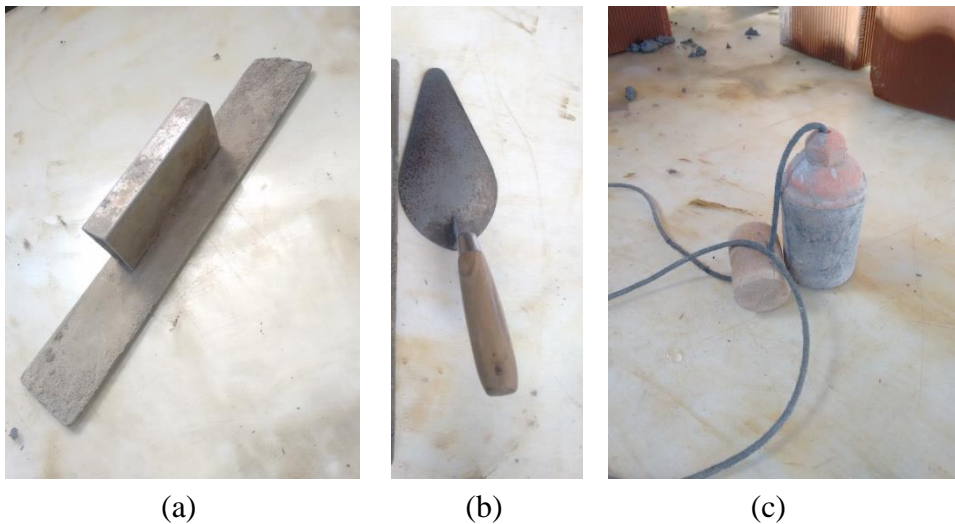
Figura 16 - Ferramentas utilizadas na montagem dos prismas (a) Palheta (b) Colher de pedreiro (c) Prumo de face
