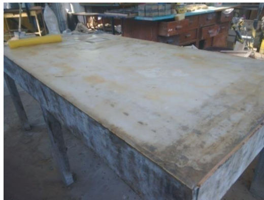
Figura 18 - Bancada para montagem dos prismas
