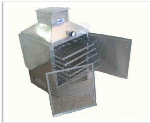
Figura 06- Desidratador em aço inox com capacidade para 08kg.
