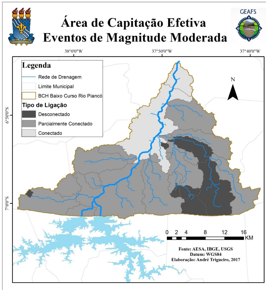
Figura 25. Figura 26. Mapa da área de captação efetiva em eventos de magnitude moderada, da BCH do baixo curso do Rio Piancó.
