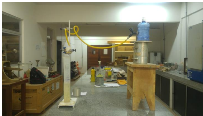
Figura 14. Esquema do permeômetro adaptado (Ferreira, 2002/ Lima,2018).
