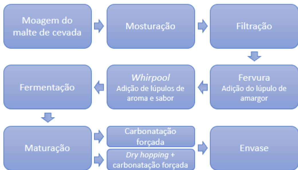
Figura 3: Fluxograma simplificado da produção das cervejas, com e sem a etapa de Dry Hopping
