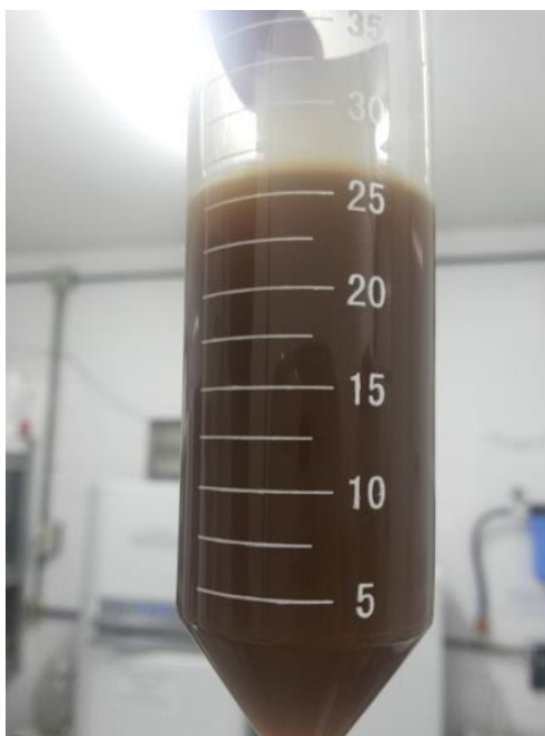
Figura 7. Extrato de levedura solúvel pós-evaporação em rotaevaporador. Fonte: Autor
